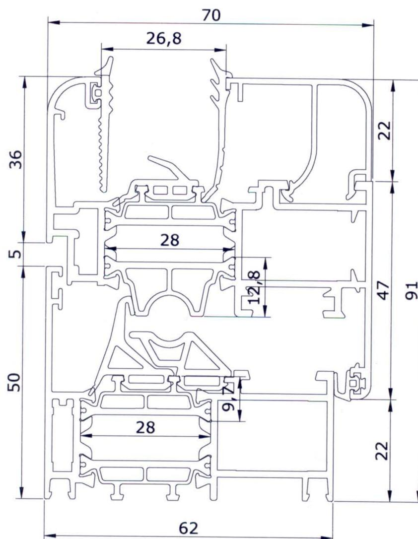
Fig. 1. Sezione del profilo in esame
