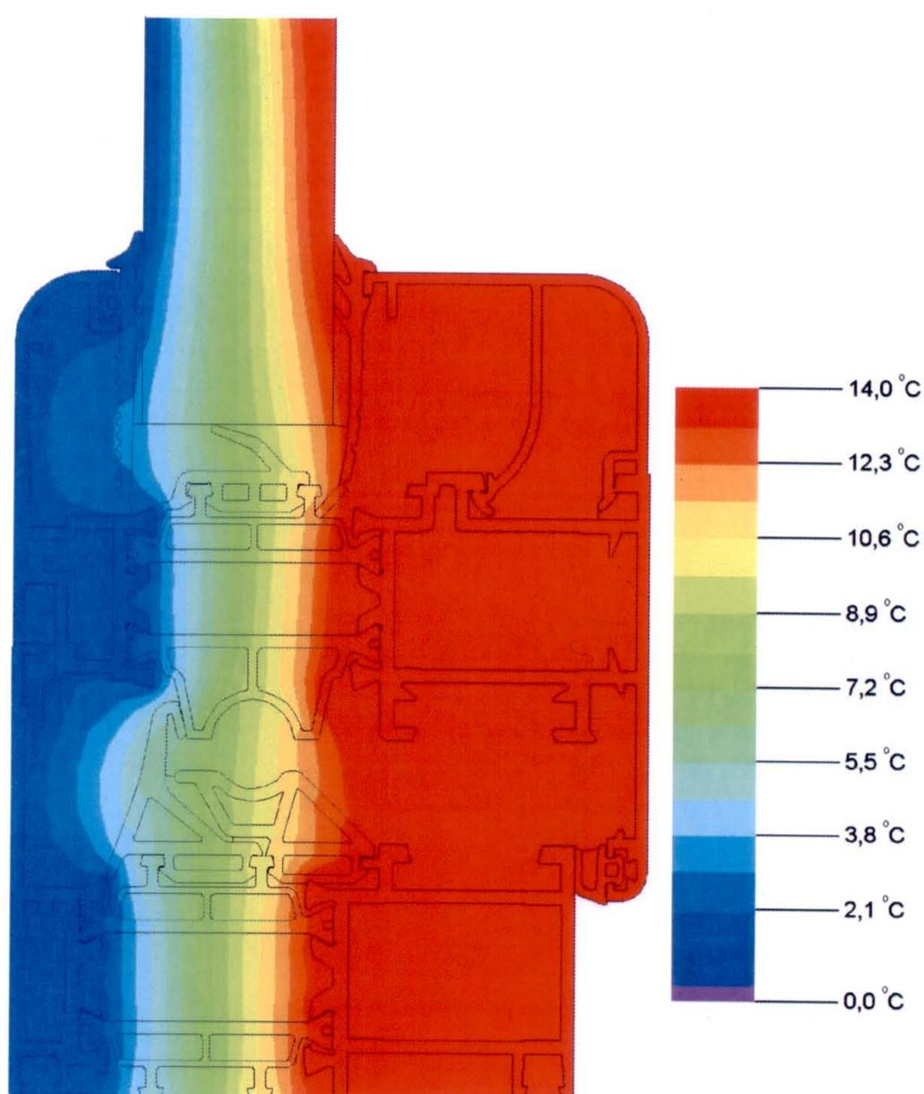
Fig. 2. Andamento delle temperature all'interno del profilo analizzato
