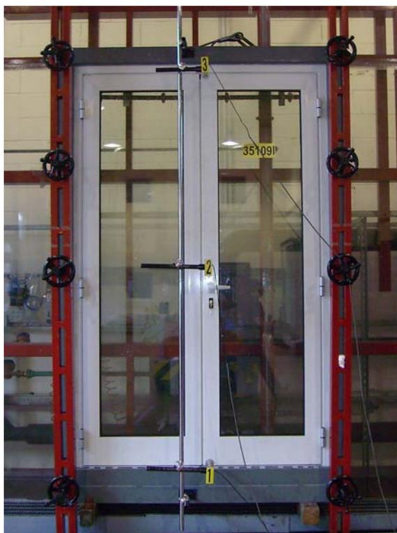
Foto 2: Campione pervenuto e sottoposto a prova durante i test di resistenza al vento (prova di deformazione)
