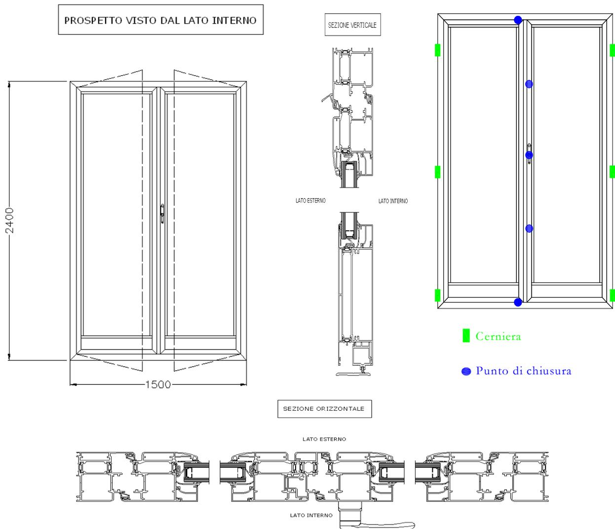
Fig. 1: Prospetto e sezioni del campione pervenuto e sottoposto a prova – vista interna e indicazione del sistema di chiusura (dimensioni nominali dichiarate, espresse in mm)
