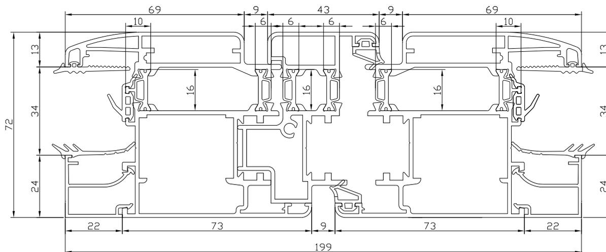
Fig. 2: Sezione del nodo centrale del campione pervenuto e sottoposto a prova (dimensioni nominali dichiarate, espresse in mm)
