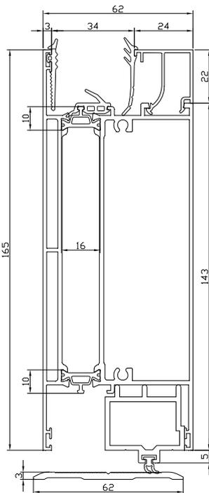
Fig. 5: Sezione del nodo inferiore del campione pervenuto e sottoposto a prova (dimensioni nominali dichiarate, espresse in mm)
