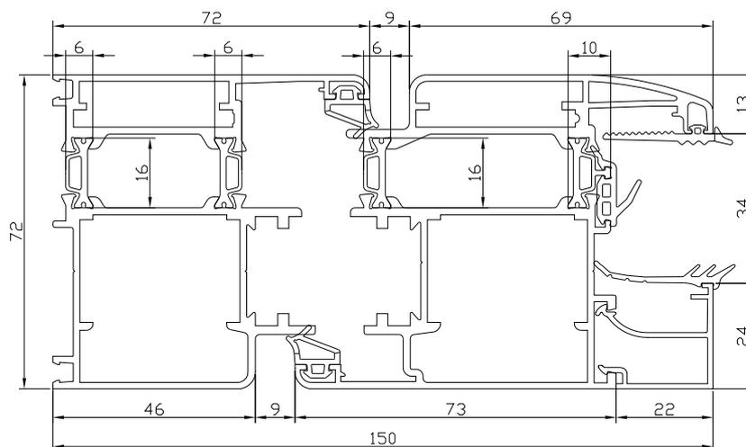
Fig. 3: Sezione del nodo laterale del campione pervenuto e sottoposto a prova (dimensioni nominali dichiarate, espresse in mm)
