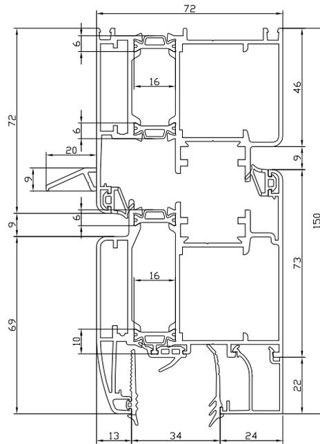
Fig. 4: Sezione del nodo superiore del campione pervenuto e sottoposto a prova (dimensioni nominali dichiarate, espresse in mm)
